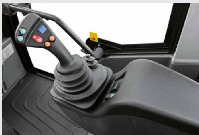
Loketní opěra a joystick tvoří se sedadlem jeden celek a přesunou se při přestavení sedadla kterýmkoli směrem. Řidič tak zůstane během dlouhých pracovních dnů déle fit.
