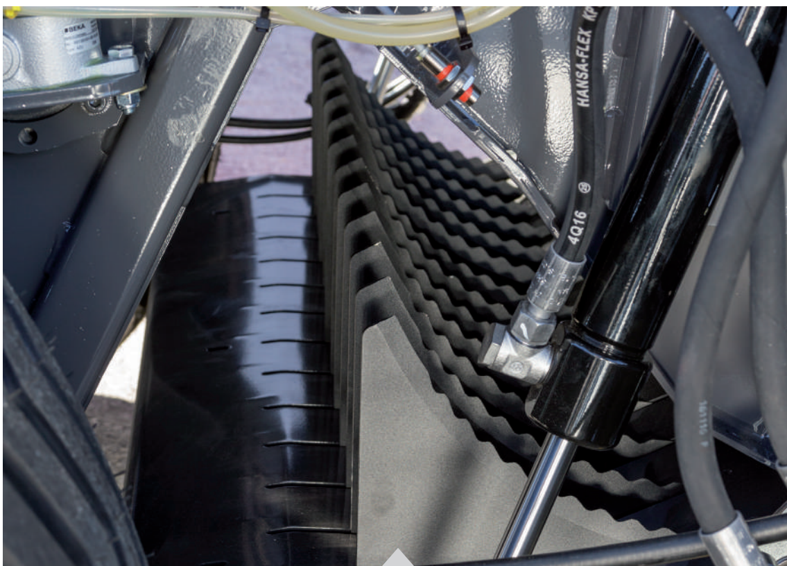
Model MF RB 2125F může být vybaven řezacím ústrojím Xtracut s 13 nebo 17 noži.
