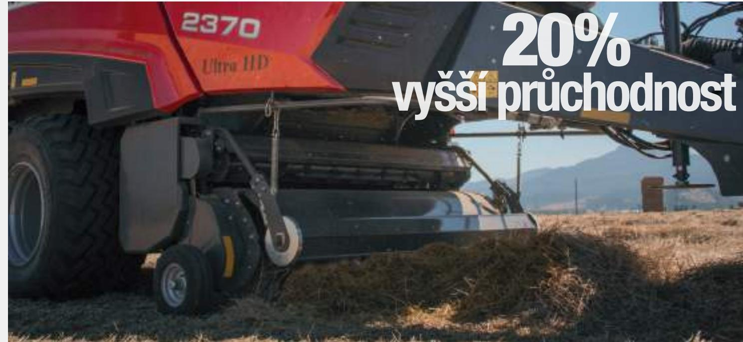
Sběrací ústrojí OptiFlow s průchodností vyšší až o 20 % zajišťuje, že lis MF 2370 Ultra HD bude stabilně dodávat maximální výkon.
