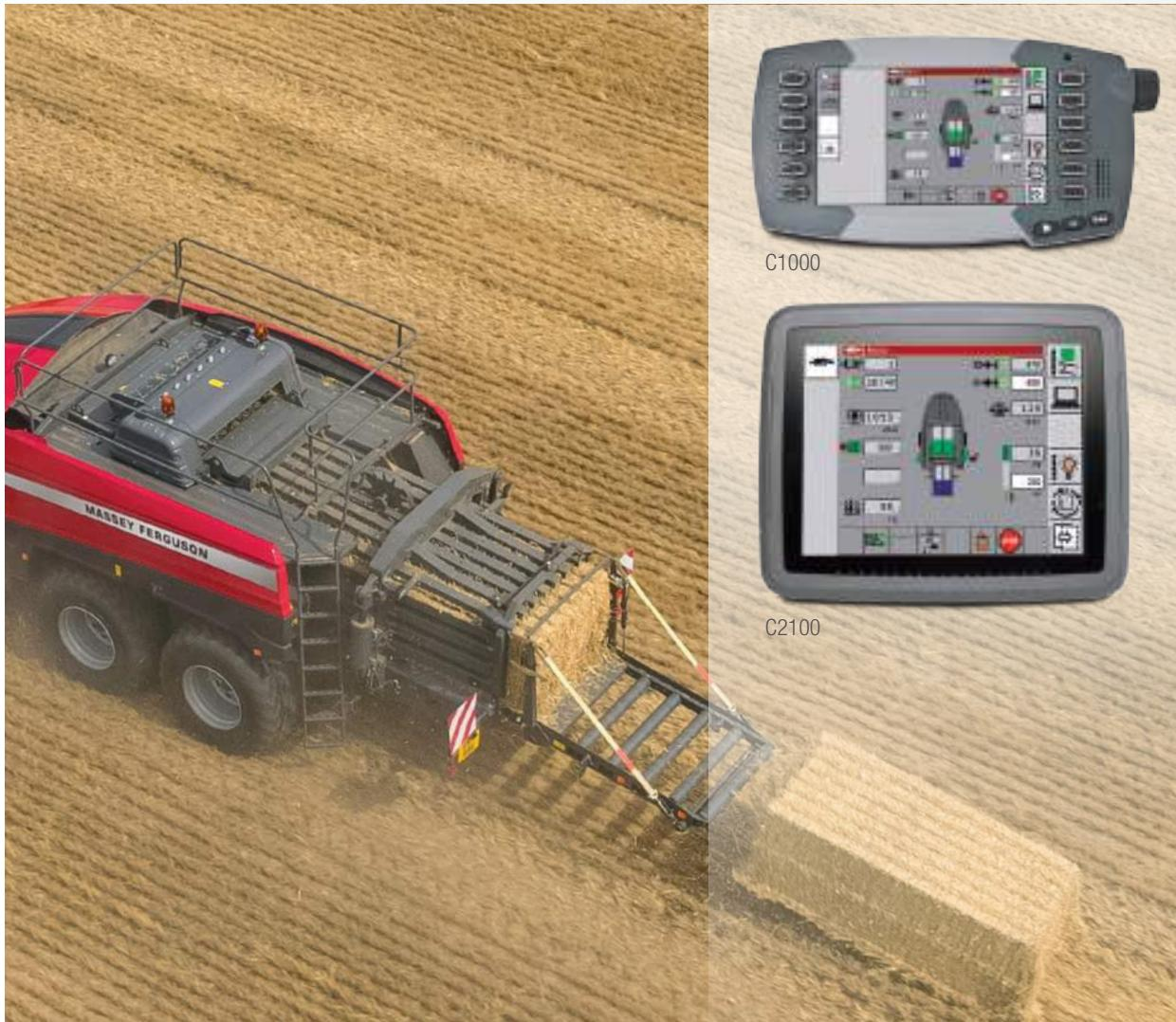
Všechny operace při lisování jsou snadno ovládány pomocí jednotky C1000, která je plně kompatibilní se sběrnicí ISOBUS, a nového uživatelského rozhraní **BaleCreate**.
